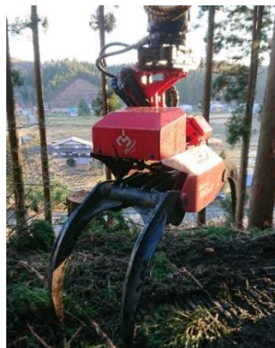
図表 44 グラップルの4本爪の構造
