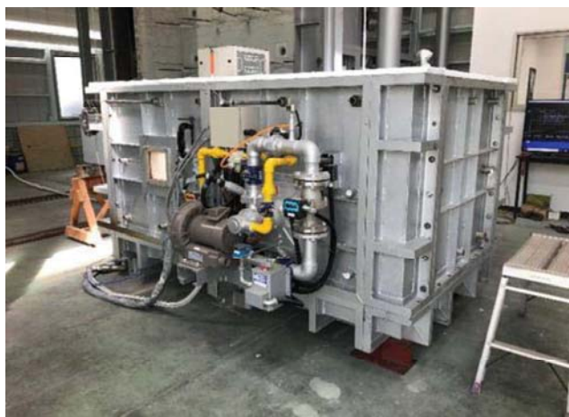
小型試験炉 全景
