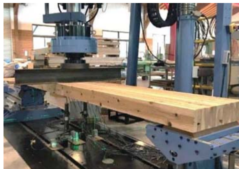
② 床の曲げ強度試験
