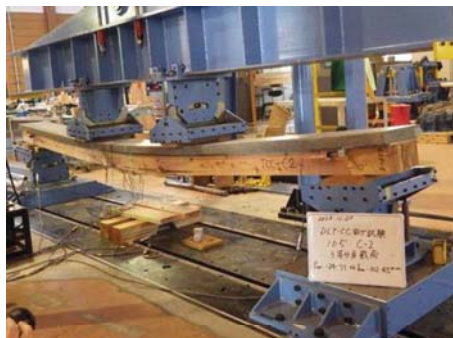
① DLT-コンクリート複合梁強度試験
