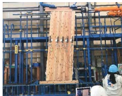
③ DLT耐力壁の面内せん断試験
